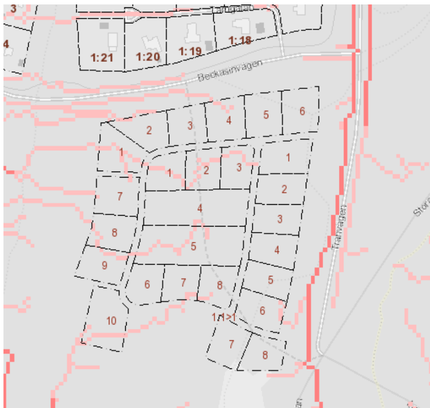
Karta: Flödesvägar dagvatten. De mörkröda flödena längs Tranvägen utgörs av djupa vägdiken, väster om planområdet av dammen och flödet ut mot avvattningspunkten i det nordvästra hörnet.
