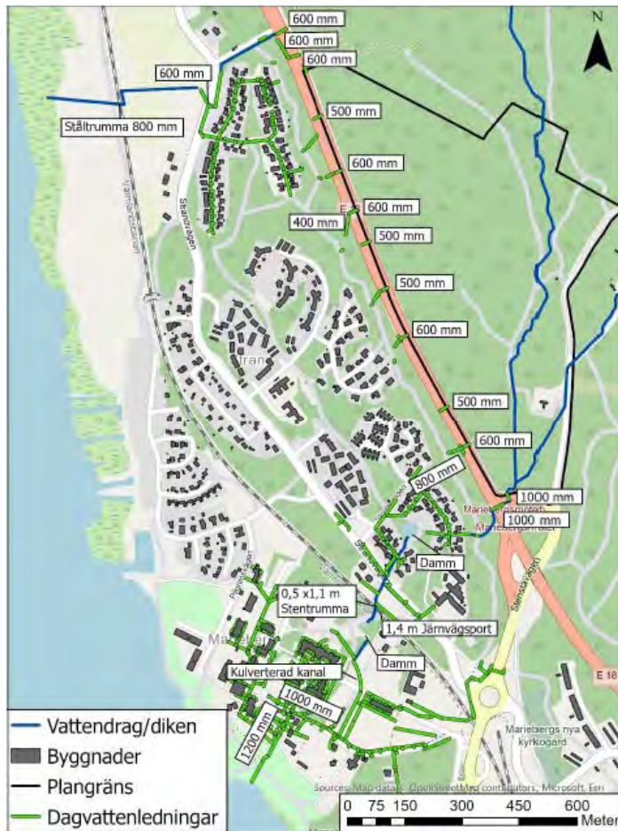
Figur 19: Befintliga dagvattenledningar och vägtrummor i anslutning till planområdet.
